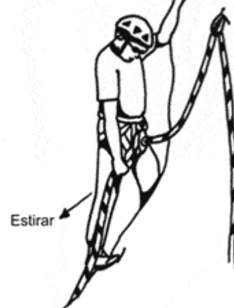
Figura 13: Desbloqueando con el peso fuera de la cuerda
