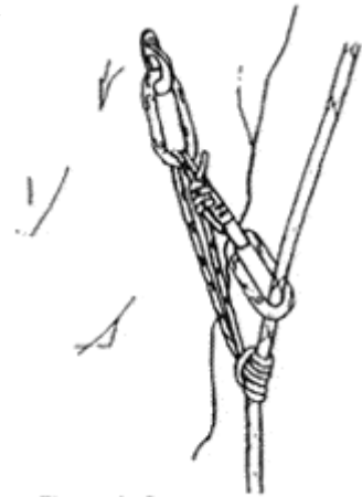
Figura 9: Soporte de la cuerda mediante un prusik
