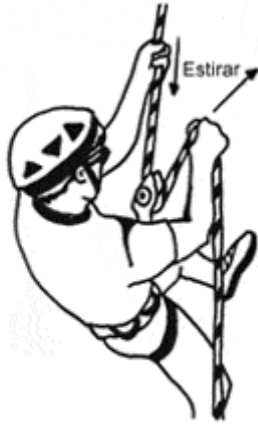
Figura 14: Desbloqueando con peso en la cuerda
